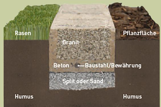
Gesetztes modagard Granit-Fertigelement im Querschnitt
